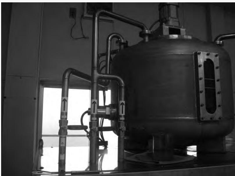
写真 9 3 反応器上部の攪拌混合タンク (メタノール 18L にKOH1600g を入れて 100L→65℃ヒーター加温しつつ 1.5hr 攪拌)
