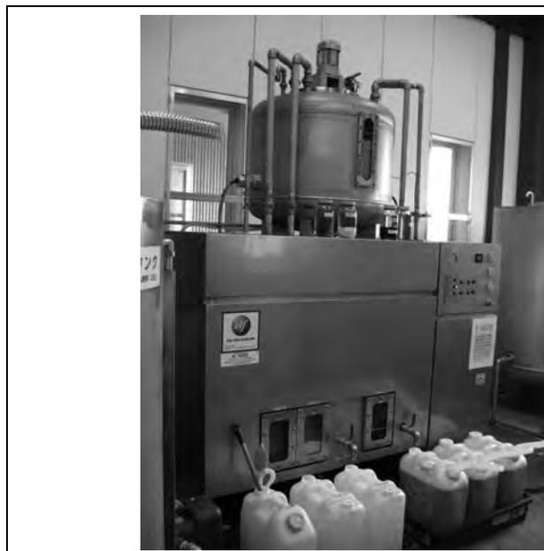
写真 8 6 BDF製造装置 (攪拌機搭載反応槽) エルフ A 3 - 2 0 0 L S W (攪拌機 : 薬品・洗浄水の 6 0 ° C 加温混合、反応槽 : グリセリン及びアルカリ水の脱水)
