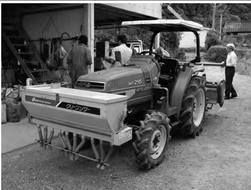
写真16 MT245トラクタ（前装式施肥機及びロータリ装着）
