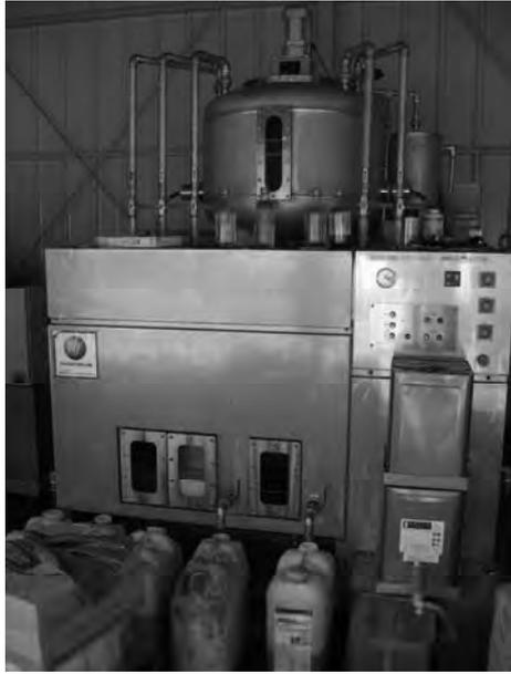
写真100 B.D.F.製造装置（エルフA3-100LSW）（廃食油 100L・メタノール 18L・水酸化カリウム 1.3kg）（あわじ菜の花エコプロジェクト）
