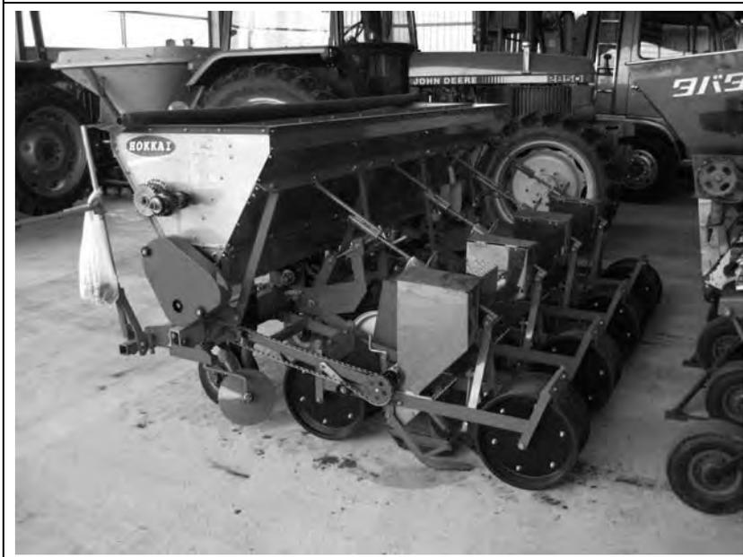
写真13 プランター（点播機）・・・溝切りディスク・施肥管・覆土ディスク＋鎮圧輪＋傾斜目皿式播種機・覆土爪＋鎮圧輪
