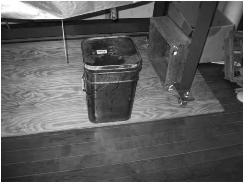
写真6 5 油容器（角の丸いものを使用する）
