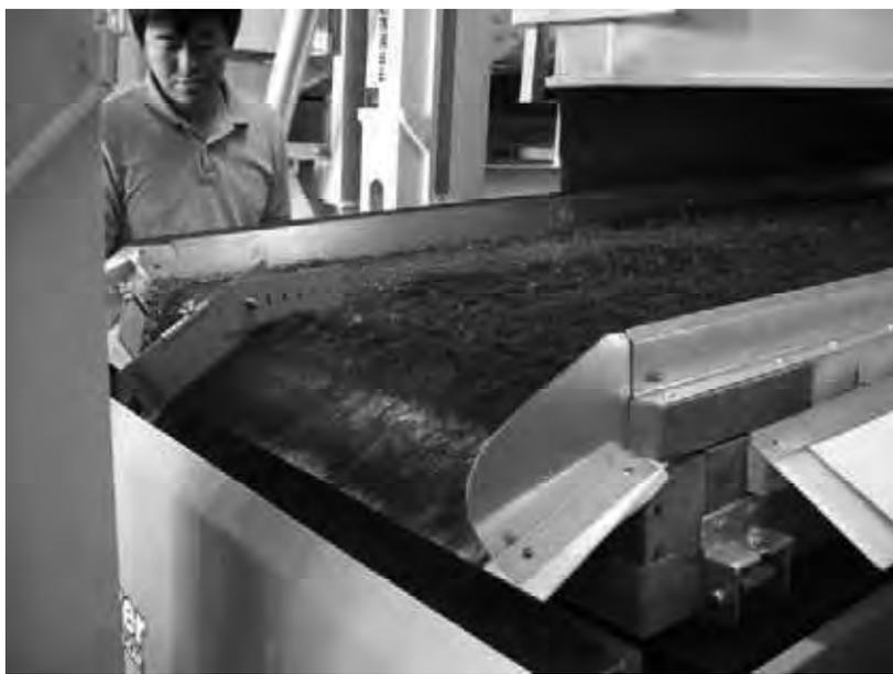
写真 4 1 Oliver 精選機による精選別状況
