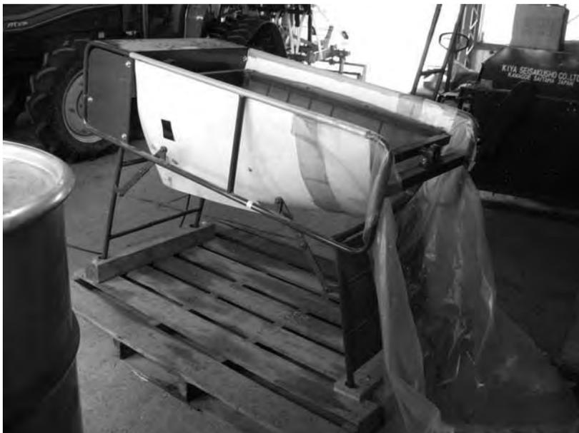
写真26 砂篩機(マゼラー産業機械、0.2kW)を改良した菜種用粗選別機(東北農業研究センター)
