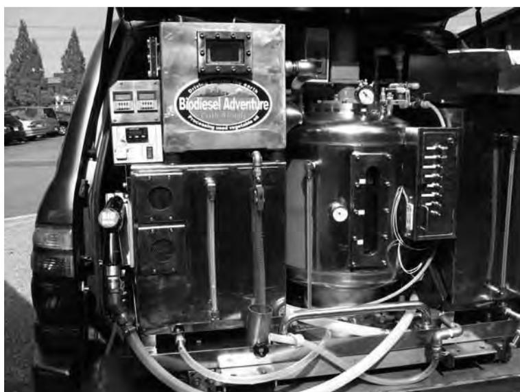
写真122 車載型乾式アルカリ触媒法 B.D.F.製造装置
