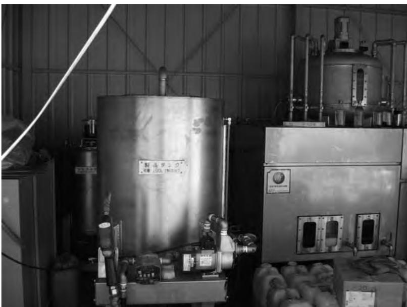
写真102 製品タンク（この奥に後処理装置）と反応器（あわじ菜の花エコプロジェクト）
