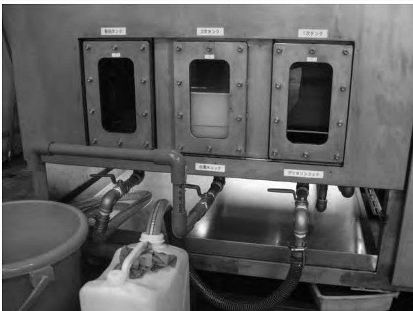
写真 9 2 反応器下部タンク : 1次タンク上澄み液→グリセリン抜き (メタノール・KOH込み) →洗淨水を加えて攪拌混合→2次タンク : 洗淨水抜き、0.5hr 3回→廃液 (白濁水) →攪拌混合タンク : 80℃ヒーター加温・減圧→100℃は上がり蒸気となって蒸発→製品タンク
