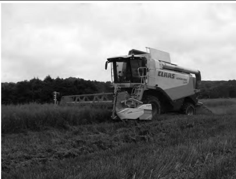
写真21 クラス・コンバインによる菜種収穫作業（350PS、刈り幅5.4m、両サイドカッター装備、フロントテーブル90cmまで前出し可能、刈高さ自動追従式、機体自動水平制御式）
