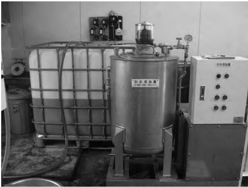
写真 9 1 (手前) 前処理装置=遠心分離機
