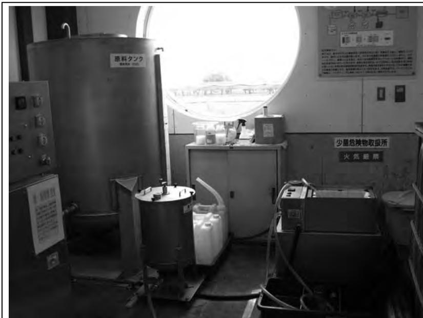
写真 8 5 (右側から) 廃食油タンク・濾過器・攪拌器・原料タンク・BDF製造装置 (操作パネル)
