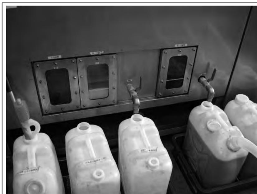
写真 8 7 (右側) 第 1 分離槽と廃液口 (グリセリン用ポリタンク)
