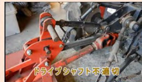
【危険】ユニバーサルジョイントがーの欠損
