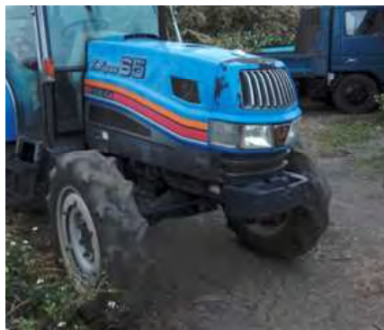
【トラクター：タイヤ摩耗・亀裂】
