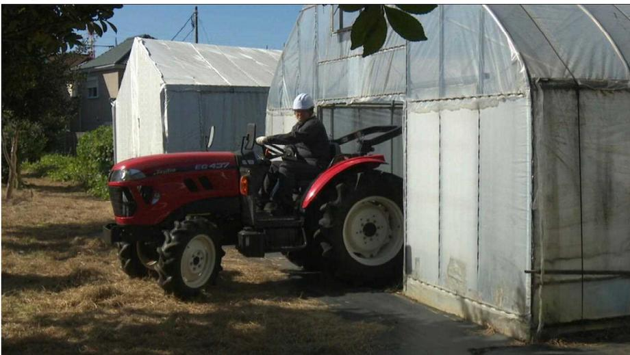
ハウスを例に、シートベルトを折りたたむ必要がある場合もあるが、それが解消したらすぐにフレームを立て、シートベルトをすべきことを説明する場面
