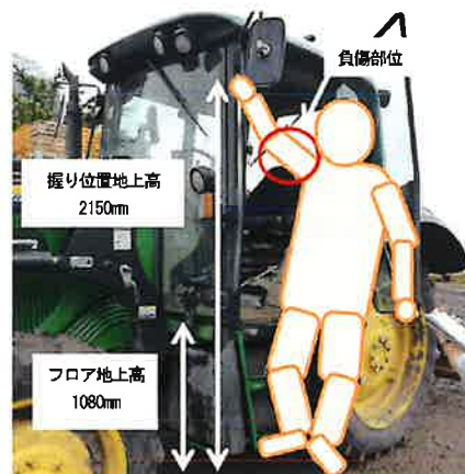
図2 被災者が乗降部から落下した際のイメージ (事故時は足が空中にあった)
